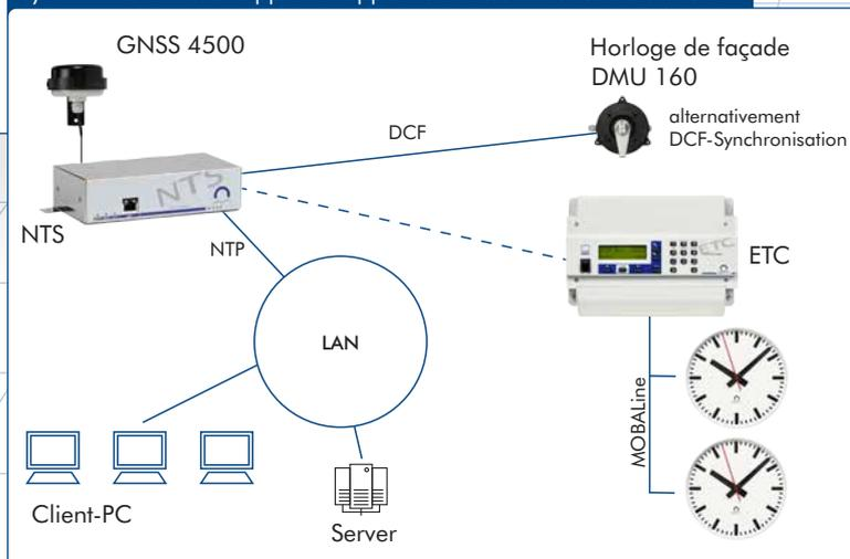
**Utilisation comme source de temps pour les systèmes de distribution de l'heure basés sur LAN** Le serveur de temps NTS transmet les signaux horaires externes avec une précision et une fiabilité maximales grâce à la synchronisation NTP. Il est compatible avec tous les appareils NTP unicast (basés sur IP) et multicast.
