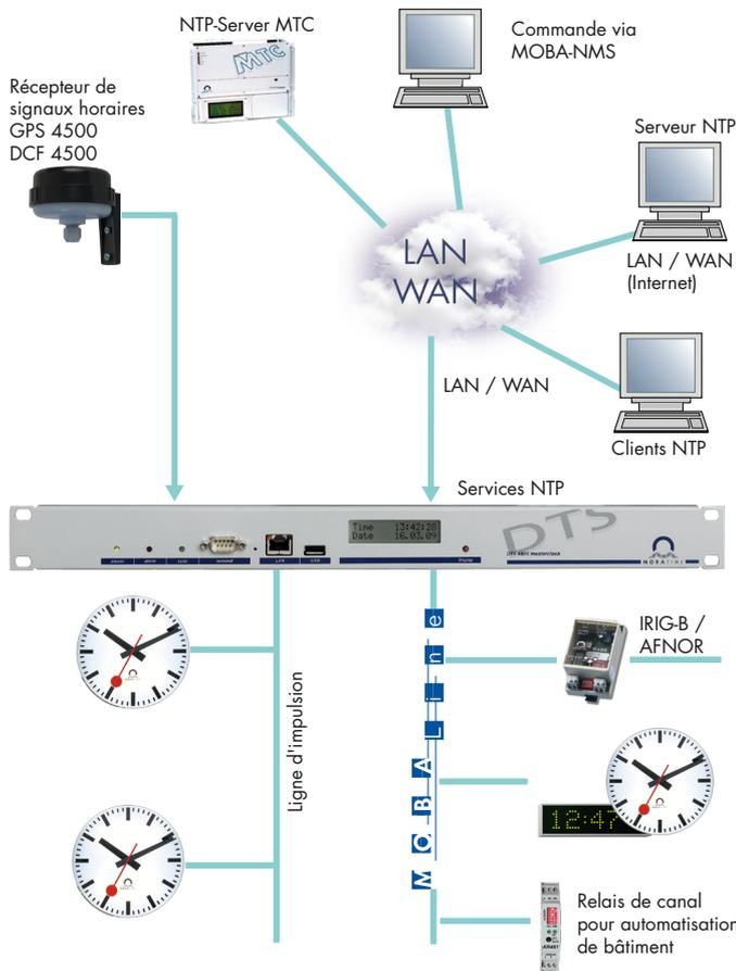
DTS 4802.masterclock comme horloge-mère à impulsion et MOBALine ainsi que serveur de temps NTP, synchronisée par un récepteur de signaux horaires (DCF 77 ou GPS) ou des serveurs NTP (LAN / Internet).
