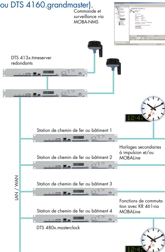
Exemple d'application dans les gares, aéroports, écoles, hôpitaux, etc.: service central avec un serveur de temps extrêmement précis comme horloge-mère master, avec disponibilité maximale. Horloges-mères slave locales pour la synchronisation de tous les appareils locaux. Contrôle d'opération à distance de tous les appareils via le LAN. Surveillance d'état/d'alarmes centrale via SNMP ou message d'alarme par e-mail.
