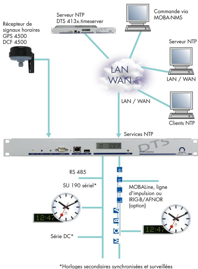
DTS 4801.masterclock pour la commande et la surveillance d'horloges secondaires sérielles à mise à l'heure automatique (y compris commande et surveillance de l'éclairage des horloges). Des horloges secondaires MOBALine ou IRIG-B/AFNOR (en option) à remise à l'heure automatique ainsi que des horloges à impulsion conventionnelles peuvent simultanément être commandées.
